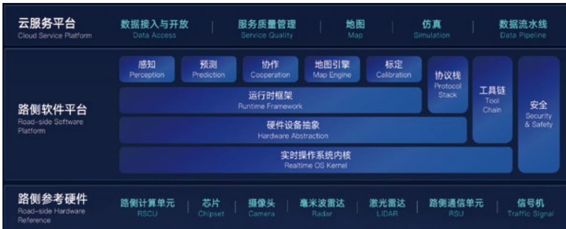
图 6.2 车路协同开放平台2.0总体架构
