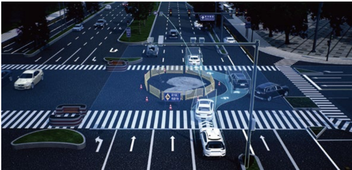
图 6.38 路口内施工绕行场景
