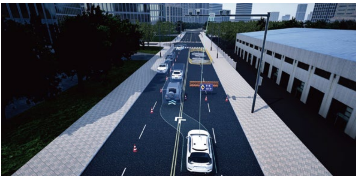
图 6.36 施工占道跨黄实线绕行
