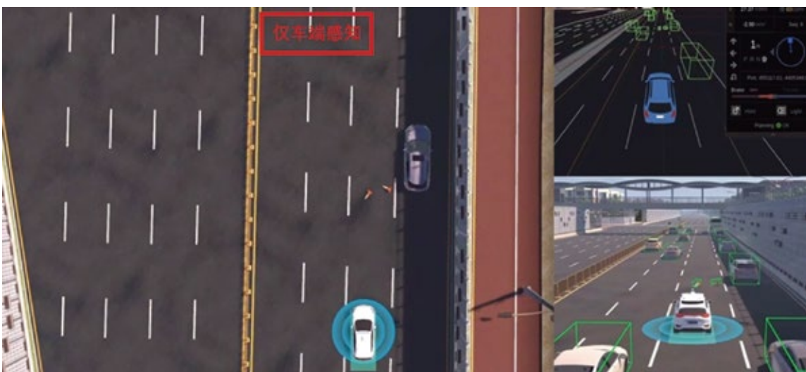
图 6.26 仅依靠AD车端感知无法在远距离对遗撒交通场景精确识别
