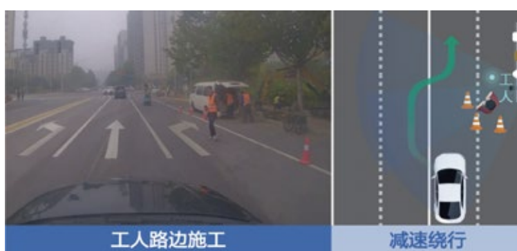
图 3.10 工人路边施工减速绕行
