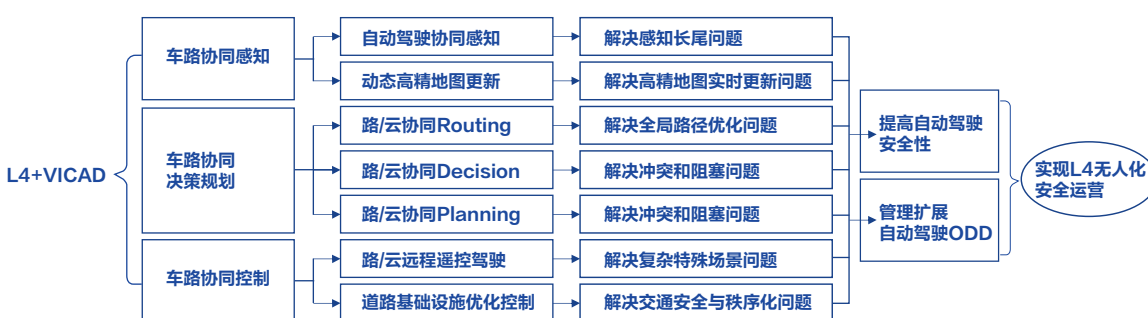
图 3.1 VICAD加速L4实现无人化自动驾驶落地路径
