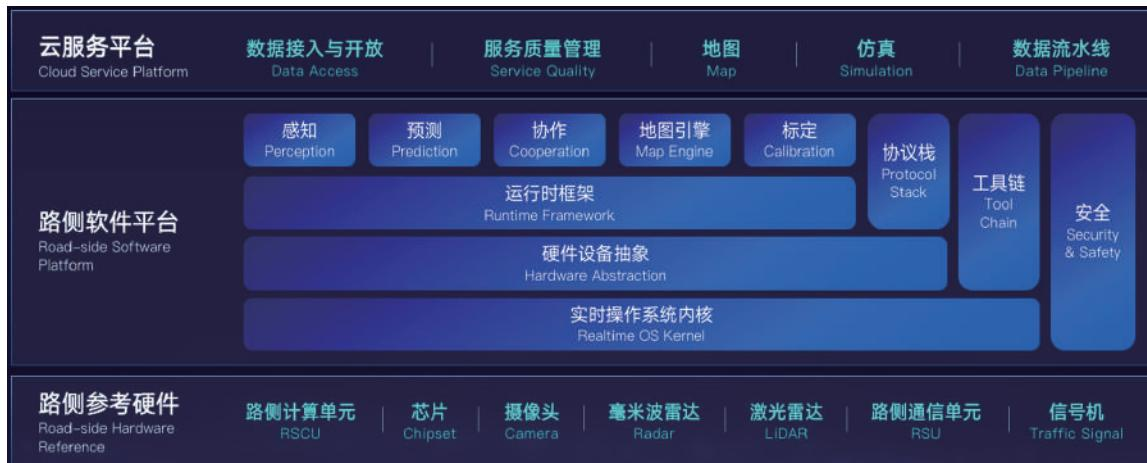
图 6.2 车路协同开放平台2.0总体架构
