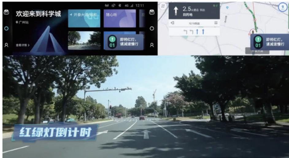
图 6.6 度小镜提供V2X红绿灯倒计时服务
