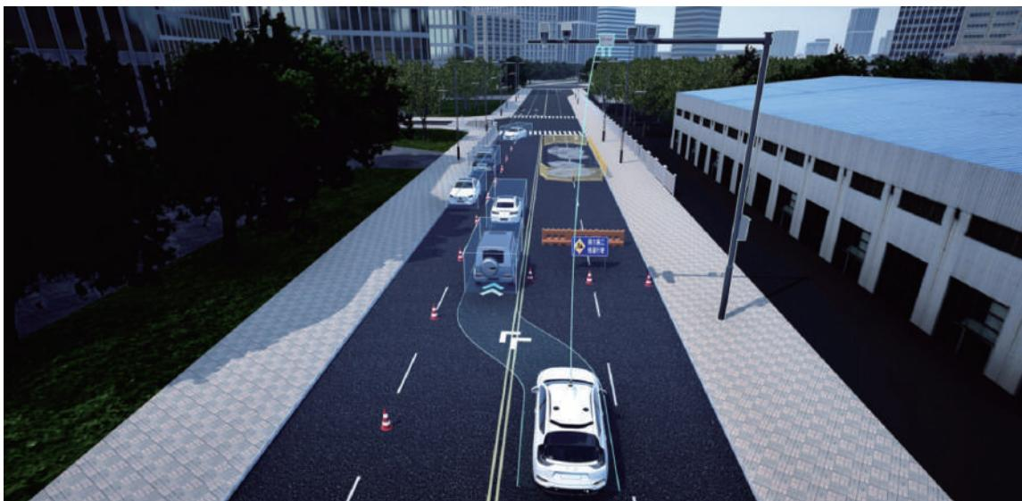
图 6.36 施工占道跨黄实线绕行
